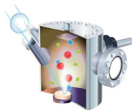
薄膜を作製するためのパルスレーザー堆積法
